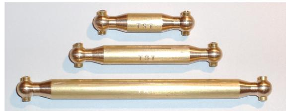
Abb. 1: Nachbau der Antriebswellen 31416, 31417 und 31418 aus Messing
