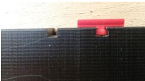
Abb. 6: Fertige Nut mit Federnocken
