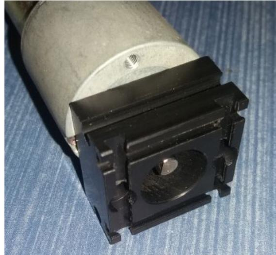
Abb. 7: Adapterbaustein für Powermotor
