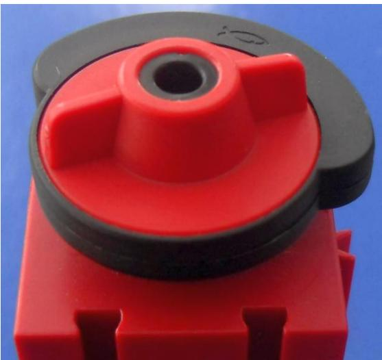
*Abb. 5: Encoder-Motor mit Schaltscheibe*
