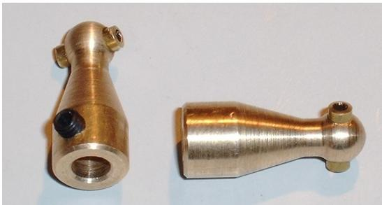
Abb. 3: Adapter für den Anschluss der Antriebswellen
