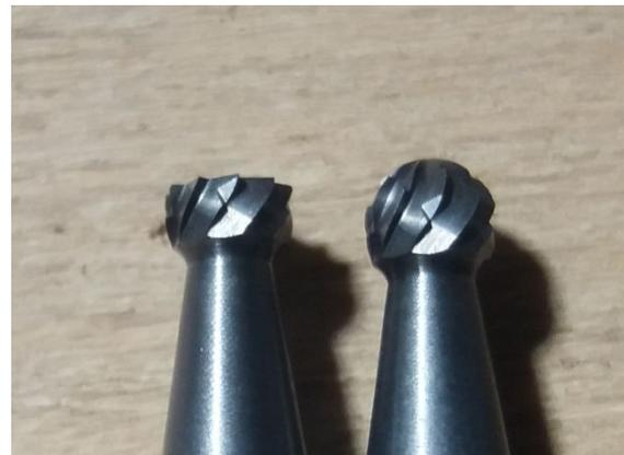
Abb. 2: Angepasster Kugelfräser
